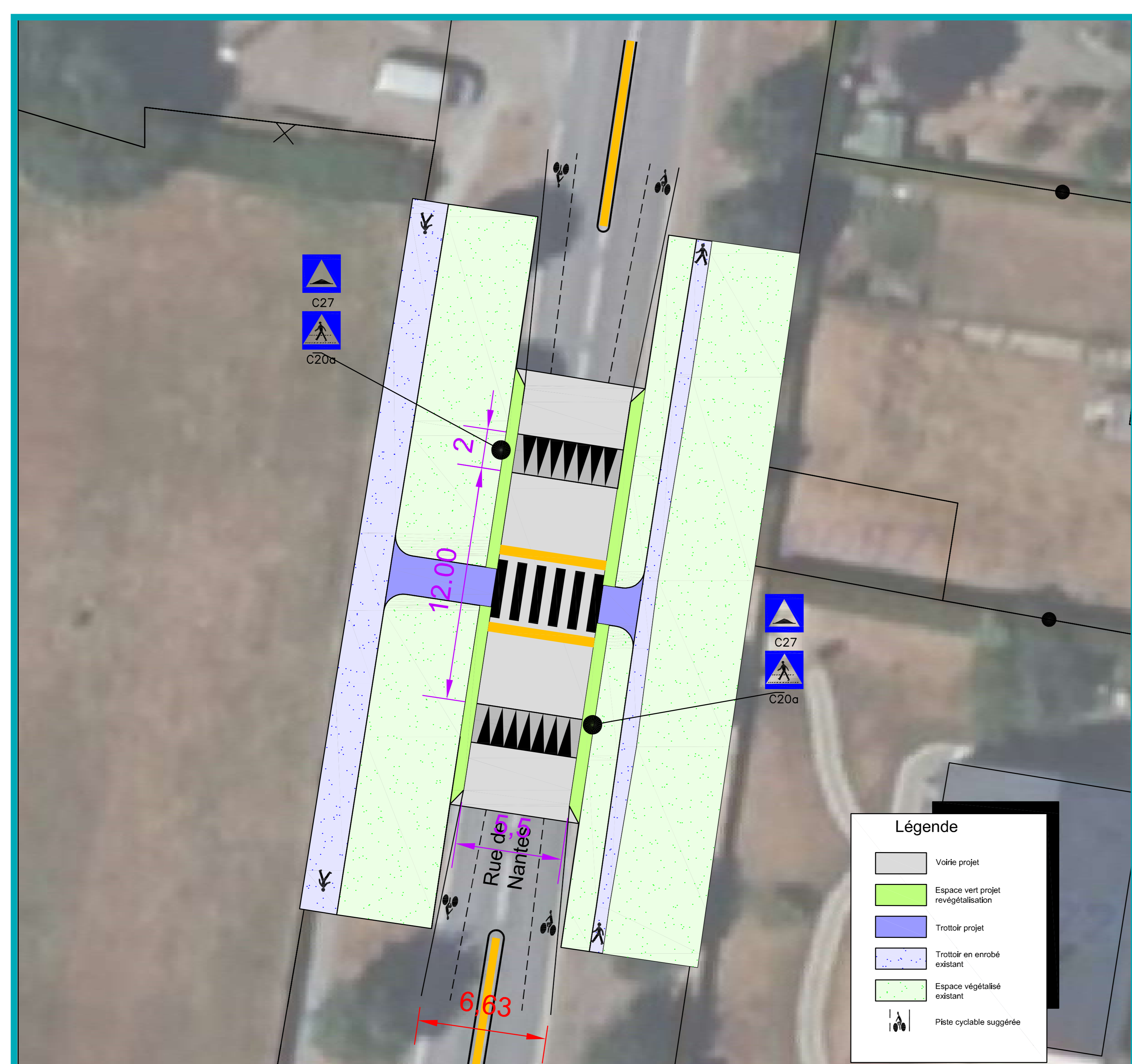
Proche garage Batard : plateau surélevé
